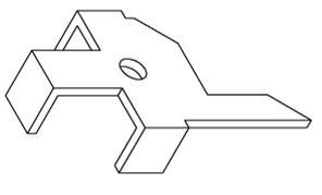
Pour un tube épaisseur 2mm, il faut insérer les 2 cales de 1mm fournies
