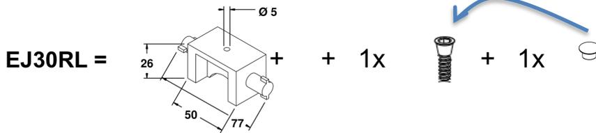
**Nota :** Assembler l'équerre EJ30L + EJ30RL avec un quart de tour AVANT de les insérer dans les tubes
